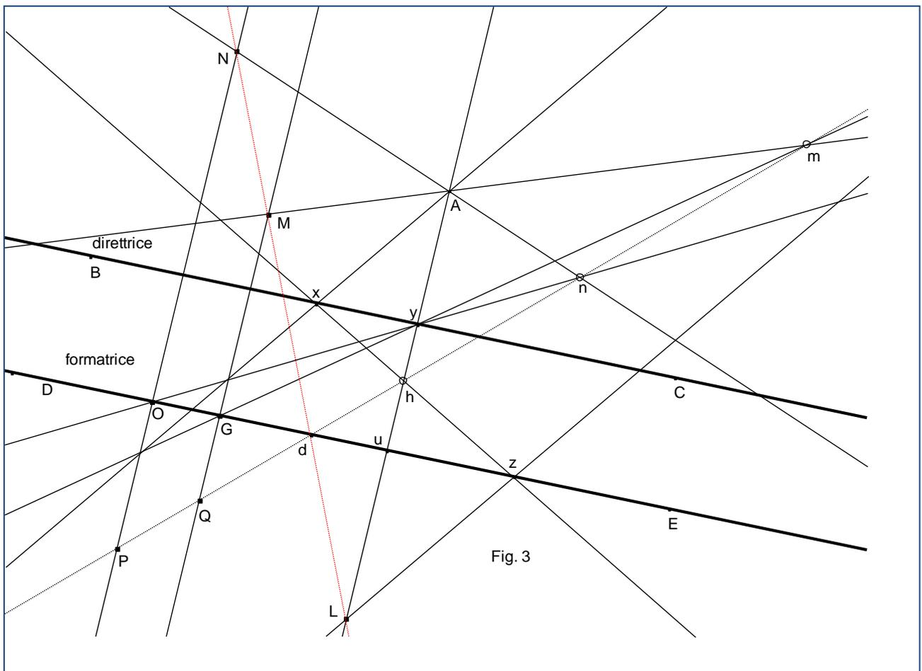
Illustriamo la costruzione della retta formata dai tre punti  $h, n, m$ . (Cfr. Fig. 3). Si traccino le rette  $Ah, An, Am$  passanti per il polo  $A$ . Una di esse (per es.  $Ah$ , prolungata se necessario) incontra la direttrice in  $y$  e la formatrice in  $u$ . Si disegnino inoltre le rette  $yn$  e  $ym$  che incontrano la formatrice nei punti  $O$  e  $G$ , poi le rette
