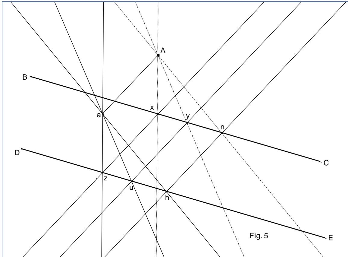
**Corollario 1.** E' evidente che la linea  $Aa$  è parallela e uguale in lunghezza alla parte di ognuna delle parallele considerate compresa fra direttrice e formatrice. (Cfr. Fig. 5).
