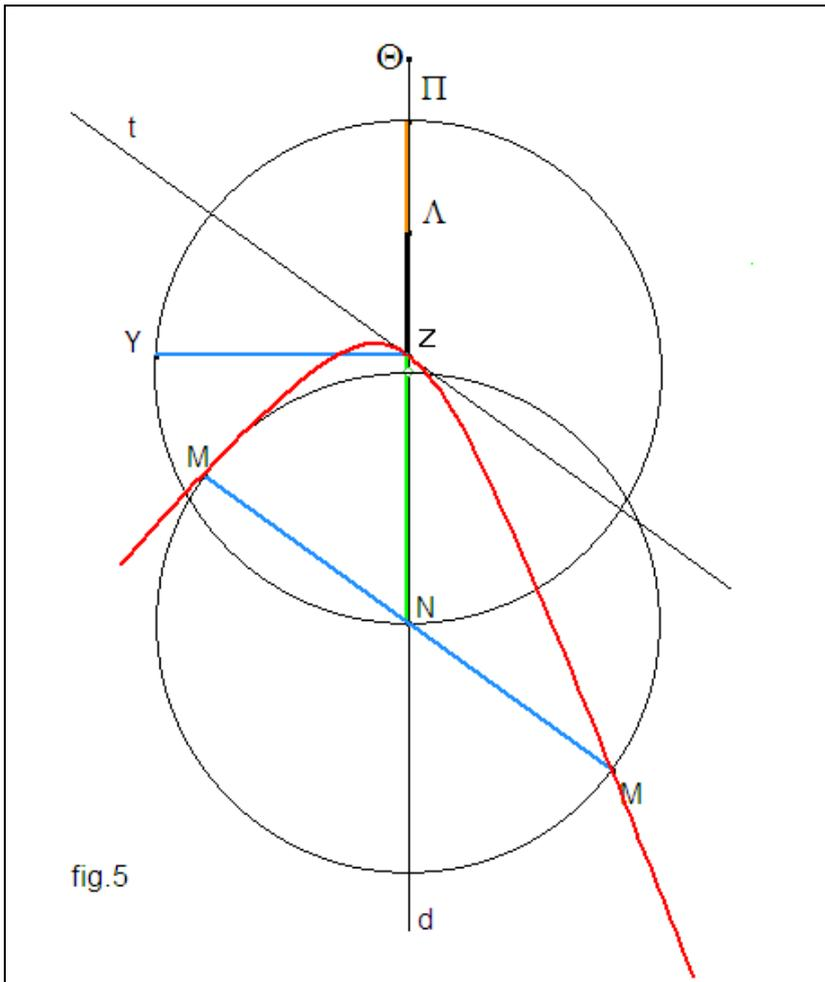
Nel caso particolare in cui il piano secante sia perpendicolare all'asse (oppure quando sono verificate le ipotesi di Menecmo) il diametro  $ZH$  diventa asse dell'iperbole sezione, e le rette  $NM$ , ordinatamente condotte rispetto all'asse, sono a questo perpendicolari.
