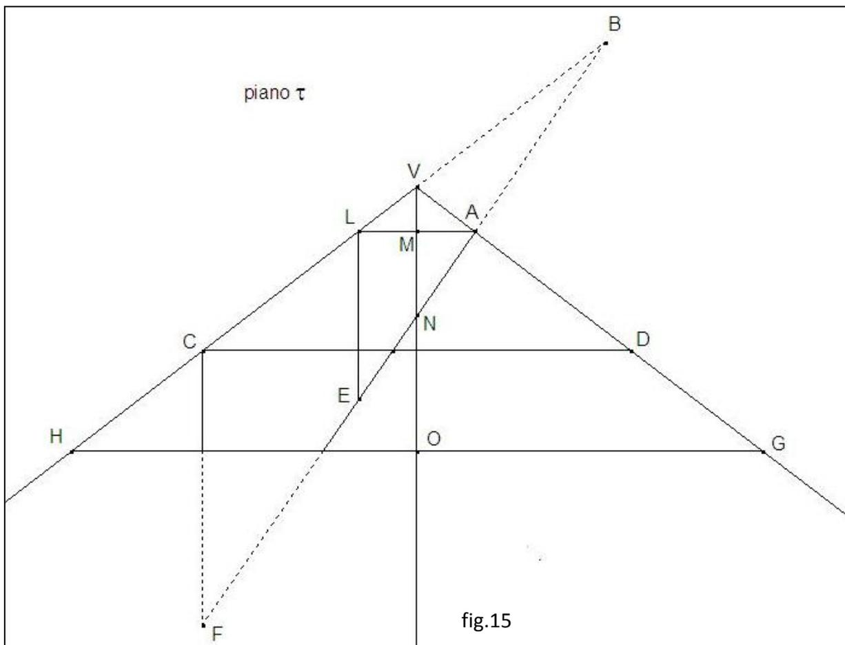
La Fig. 15 è ricavata dalla Fig. 14 con la seguente costruzione: si è tracciato AL (parallelamente a CD e ad HG, quindi alla base del cono), poi VO (asse del cono, altezza del triangolo per l'asse) che incontra AL in M e AB in N; infine da L e da C si sono condotte le parallele ad AO fino ad incontrare AB rispettivamente in E ed F. In questo caso  $VA \neq AN$ : il segmento AN (che rappresenta la distanza tra A e il punto N
