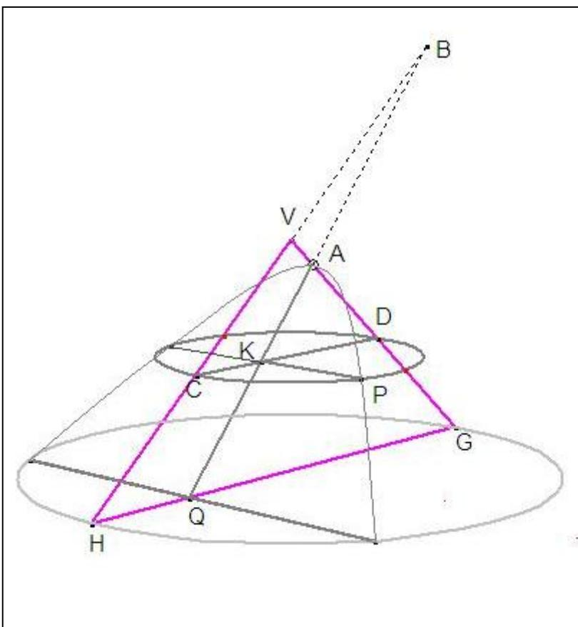
*In fig. 11 sono messi in evidenza i tre piani che servono alla deduzione del sintomo. Il piano del triangolo per l'asse ( $\tau$ ) è individuato dai punti  $V, H, G$ ; il piano secante ( $\sigma$ ) è individuato dai punti  $A, P, Q$ ; il piano ( $\beta$ ) passante per  $P$  e parallelo alla base del cono è individuato dai punti  $P, D, C$  che appartengono alla circonferenza intersezione di tale piano col cono.*
