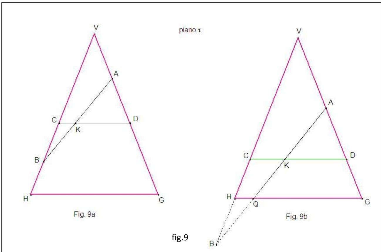
In Fig.9 (dove il piano del disegno coincide col piano  $\tau$ ) vediamo invece il triangolo VHG (triangolo per l'asse) generato da  $\tau$  intersecando il cono, mentre AB (Fig. 9a) (oppure AQ: Fig. 9b) è l'intersezione tra  $\tau$  e  $\sigma$ , CD quella tra  $\tau$  e  $\beta$ . (Nella Fig. 9b è stato necessario prolungare AQ e VH per avere il punto B).
