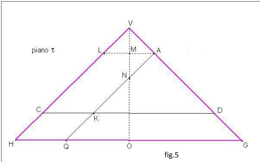
La Fig. 5 è ricavata dalla Fig. 4 con la seguente costruzione: sono stati tracciati AL (parallelamente ad HG e CD, quindi alla base del cono) e VO (asse del cono, altezza del triangolo per l'asse) che incontra HG in M e CD in N.
