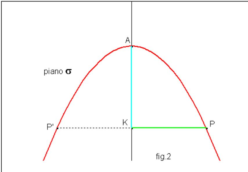
Dato un cono circolare retto e rettangolo (ottenuto quindi per rotazione attorno ad un cateto di un triangolo rettangolo isoscele), lo si intersechi con un piano  $\sigma$  passante per il punto A di una generatrice (ipotenusa del triangolo generatore) e a questa perpendicolare. Si ottiene come sezione la
