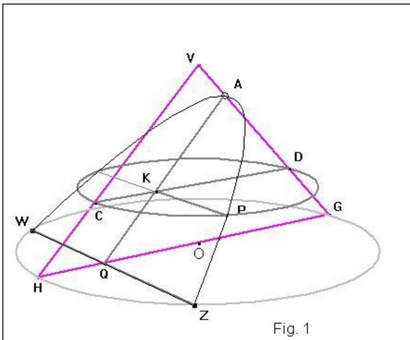
*In Fig. 1 sono messi in evidenza i tre piani che servono alla deduzione del sintomo. Il piano del triangolo per l'asse ( $\tau$ ) è individuato dai punti V, H, G; il piano secante ( $\sigma$ ) è individuato dai punti A, W, Z; il piano ( $\beta$ ) passante per P e parallelo alla base del cono è individuato dai punti P, D, C che appartengono alla circonferenza intersezione di tale piano col cono.*
