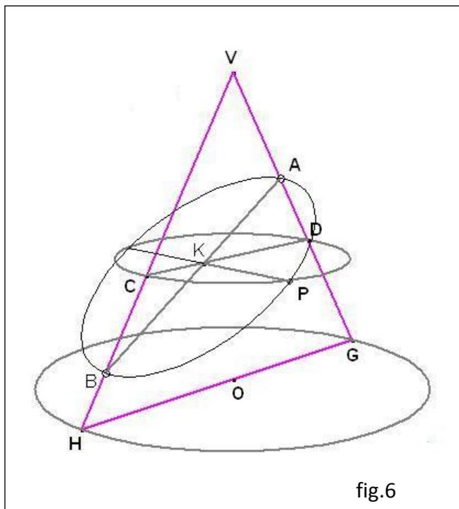
*In Fig. 6 sono messi in evidenza i tre piani che servono alla deduzione del sintomo. Il piano del triangolo per l'asse ( $\tau$ ) è individuato dai punti V, H, G; il piano secante ( $\sigma$ ) è individuato dai punti A, P, B; il piano ( $\beta$ ) passante per P e parallelo alla base del cono è individuato dai punti P, D, C che appartengono alla circonferenza intersezione di tale piano col cono.*
